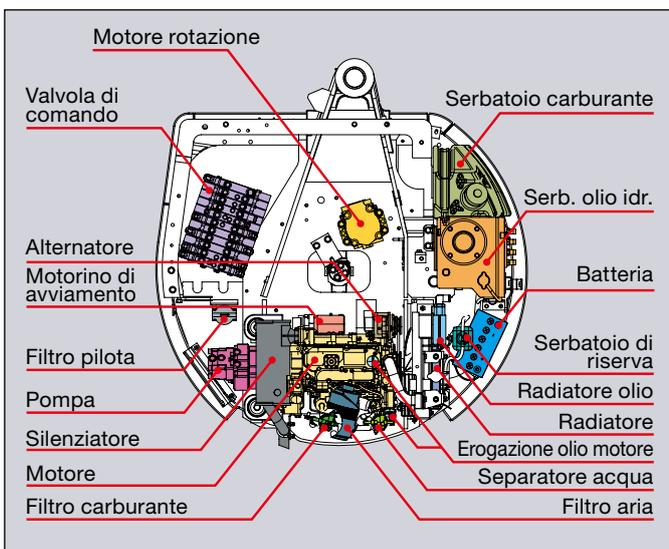
I modelli ZX22U-2 presentano la stessa disposizione dei componenti per consentire operazioni di controllo e sostituzione semplici ed efficienti. I punti di ispezione sono concentrati per consentire una rapida manutenzione quotidiana.
