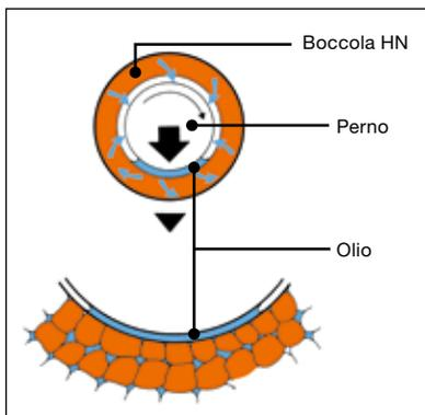
Le boccole HN rappresentano un altro esempio della tecnologia innovativa sviluppata da Hitachi e offrono caratteristiche di lunga durata ed elevata resistenza. Il metallo sinterizzato di elevata durezza di cui sono costituite è impregnato di olio ad alta viscosità. Durante il funzionamento, l'olio trasuda dai pori della boccola fra le superfici di contatto tra perno e boccola, lubrificando automaticamente i componenti.
