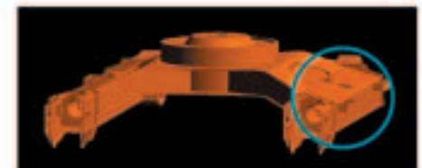
**Sottocarro progettato per una facile rimozione del fango**
