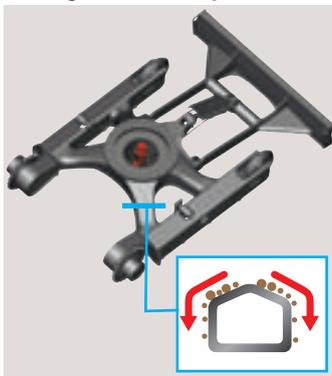
Il telaio cingoli con traversa a X è arrotondato per una semplice rimozione del fango. L'inclinazione sul lato del telaio cingoli agevola il distacco del fango, riducendo al minimo problemi di incrostazioni. Ne conseguono un minor tempo di lavaggio della macchina e la riduzione dei costi di smaltimento.
