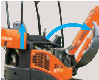
Il carter motore può scorrere verso l'alto e verso il basso per una rapida manutenzione anche in spazi angusti. Non viene più impiegato il carter incernierato che rende difficoltose le operazioni di manutenzione. Il carter di destra ribaltabile consente un rapido controllo della batteria.
