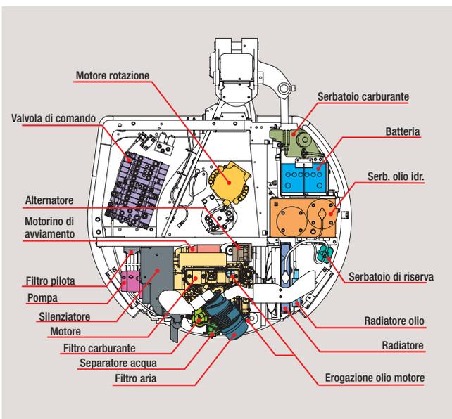
I modelli ZX27U-2 presentano la stessa disposizione dei componenti per consentire operazioni di controllo e sostituzione semplici ed efficienti. I punti di ispezione sono concentrati per consentire una rapida manutenzione quotidiana.
