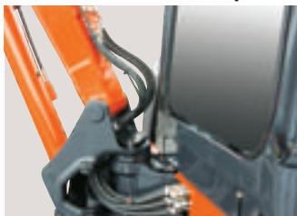
I flessibili anteriori a più elementi sono collegati sui fori di copertura della macchina e sulla parte posteriore del braccio di sollevamento per renderne semplice la sostituzione.
