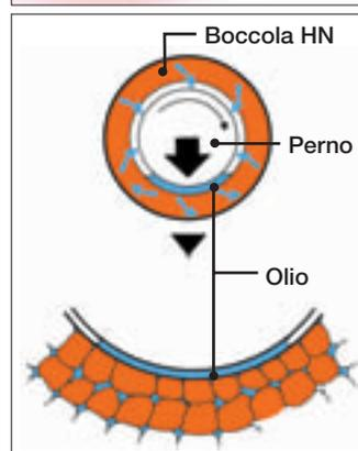
Le boccole HN rappresentano un altro esempio della tecnologia innovativa sviluppata da Hitachi e offrono caratteristiche di lunga durata ed elevata resistenza. Il metallo sinterizzato di elevata durezza di cui sono costituite è impregnato di olio ad alta viscosità. Durante il funzionamento, l'olio trasuda dai pori della boccola fra le superfici di contatto tra perno e boccola, lubrificando automaticamente i componenti.
