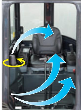
Il climatizzatore compatto, ma di ampia capacità è di serie. Il bocchettone ruotabile a 360° funge anche da sbrinatori, preservando il comfort dell'operatore per tutto l'anno.
