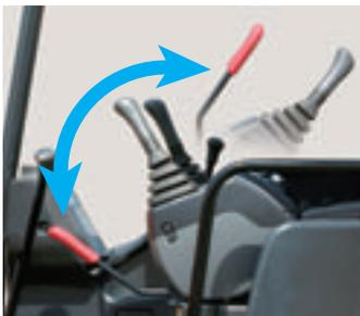
Tutte le funzioni (attrezzo anteriore, rotazione, traslazione e lama) possono essere disattivate bloccando la valvola di neutralizzazione del circuito di pilotaggio. In questo modo viene efficacemente impedito l'azionamento accidentale delle leve.
