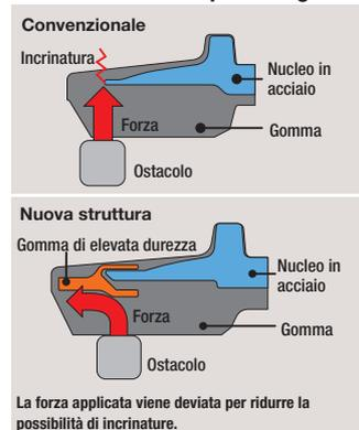
I cingoli in gomma progettati da Hitachi garantiscono una lunga durata, grazie alla struttura con nucleo in acciaio che protegge i bordi delle costole da danni anche durante il superamento di ostacoli.
