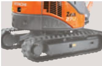
Durante la traslazione ad alta velocità, quando ad esempio il carico viene incrementato per sterzare, la velocità di traslazione viene ridotta in modo automatico e omogeneo. Quando il carico diminuisce, la velocità di traslazione precedente viene ripristinata.
