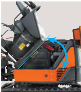
La cabina può essere ribaltata per operazioni di manutenzione semplici e rapide anche in caso di emergenza. La cabina può essere ribaltata fino a 50° per consentire all'operatore di lavorare sotto il pavimento stesso. Viene inoltre consentito l'accesso diretto al meccanismo di rotazione e al motorino di avviamento dietro il motore situati sotto il pavimento della cabina. Questo design riduce i tempi di controllo e manutenzione.
