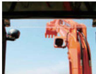
L'aletta parasole, parte integrante del tetto, consente una migliore visibilità verso l'alto. Il tetto sporgente mantiene asciutte le ginocchia dell'operatore in caso di pioggia leggera.
