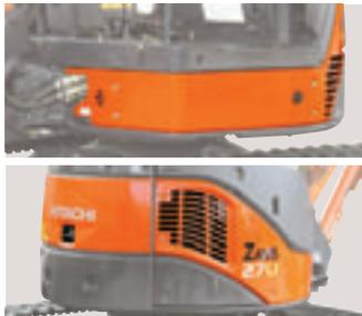
Per le operazioni pesanti viene utilizzata una copertura in acciaio che consente una semplice riparazione in caso di danni. La copertura in acciaio è durevole, riciclabile ed economica.
