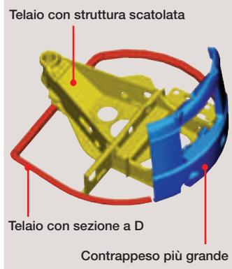
E' stato adottato un telaio con struttura scatolata di nuova concezione che unisce leggerezza ed elevata durabilità. Il contrappeso più grande e il sottocarro robusto contribuiscono ad abbassare il centro di gravità e ad aumentare la stabilità.
