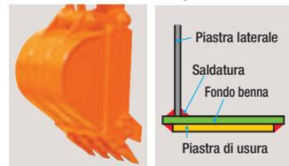
La benna a fondo piatto viene fornita di serie per ridurre al minimo l'usura del fondo stesso. Ampie piastre di usura sono saldate sul fondo della benna per aumentarne la durabilità.
