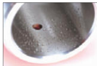
Le collaudate boccole HN, originali Hitachi, vengono impiegate su ogni perno anteriore per ridurre le sollecitazioni e le operazioni di manutenzione. Gli intervalli di lubrificazione hanno una durata di 500 ore.
