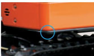
Il telaio della macchina è rinforzato con il bordo a sezione D per la protezione dai danni e dagli impatti con ostacoli.
