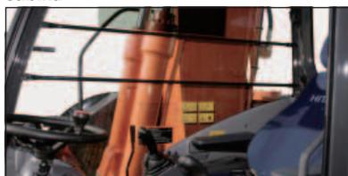
**Leva di esclusione circuito di pilotaggio**
