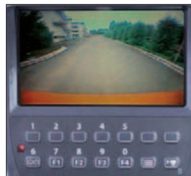
Il monitor LCD a colori widescreen, insieme alla videocamera per la retrovisione situata sul contrappeso, offre una comoda veduta dell'area retrostante la macchina. La videocamera per la retrovisione entra automaticamente in funzione durante la traslazione indietro, ma può anche essere accesa manualmente tramite l'apposito tasto sul monitor.
