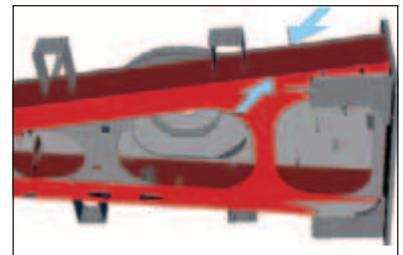
Le sezioni trasversali del telaio sono state allargate.
