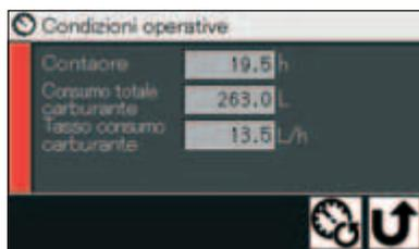
Viene calcolato il consumo di carburante per ogni ora di funzionamento e il risultato viene visualizzato sul monitor LCD. Questo dato suggerisce i tempi di rifornimento carburante e fornisce un'indicazione sulle operazioni a risparmio energetico e la gestione efficace dei lavori.
