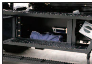
L'unità è dotata di una cassetta attrezzi di grande capacità ed abbastanza ampia da riporre un contenitore metallico. La cassetta può essere utilizzata come uno spazio versatile per riporre attrezzi e pistole di ingrassaggio.
