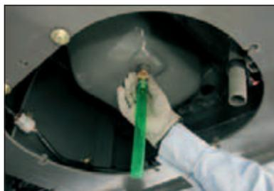
La coppa dell'olio motore è provvista di un attacco rapido per la sostituzione dell'olio motore: per eseguire lo spurgo, all'attacco viene collegato un flessibile di drenaggio. Il tappo per lo spurgo è affidabile ed impedisce perdite di olio e atti vandalici.
