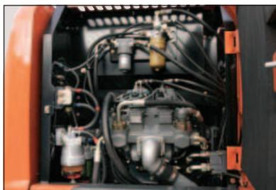
Le larghe porte consentono di accedere, da terra, al filtro del carburante, al separatore dell'acqua e al filtro dell'olio motore. L'olio idraulico può essere usato per massimo 5.000 ore.
