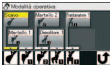
Quando si sostituisce un accessorio, la portata dell'olio può essere regolata automaticamente tramite il display di selezione della modalità di lavoro sul monitor LCD. Se necessario è possibile apportare correzioni minime alla portata dell'olio.
