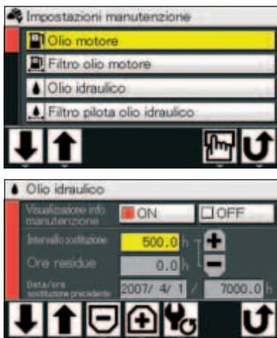
Ogni volta che si ruota la chiave di accensione, il monitor LCD fornisce indicazioni sugli intervalli di manutenzione per l'olio idraulico e i filtri carburante, in base al programma preimpostato dall'utente. Una corretta manutenzione programmata contribuisce ad evitare danni e guasti alla macchina.
