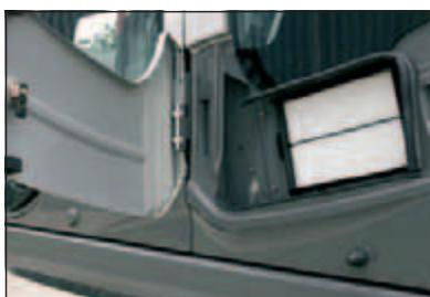
Il filtro per l'aria esterna del climatizzatore è stato spostato e invece che alle spalle del sedile dell'operatore si trova sul lato dov'è lo sportello della cabina. In questo modo è facile pulire e sostituire il filtro, come pure il filtro di circolazione dell'aria all'interno della cabina.
