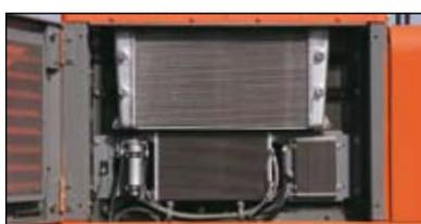
Invece che nel tradizionale schema in linea, il radiatore dell'olio e quello dell'acqua sono disposti in parallelo, per agevolarne lo smontaggio. Questa nuova disposizione semplifica sensibilmente gli interventi di pulizia nell'area del motore.
