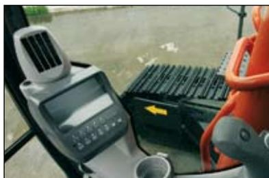
Il monitor LCD a colori in cabina indica la temperatura del refrigerante, il livello del combustibile e i dati sulla manutenzione. Consente anche di regolare l'accessorio con un semplice tocco. Il display può essere regolato per il turno diurno o notturno.
