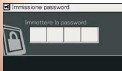
Onde evitare furti e atti vandalici, l'immobilizzatore elettronico richiede l'inserimento di un codice crittografico nel monitor multifunzione ogni volta che si avvia il motore.
