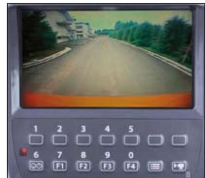
L'LCD a colori widescreen offre anche la veduta sul lato posteriore della macchina. La maggiore sicurezza durante la rotazione e la marcia costituisce un vantaggio chiave. La videocamera di retrovisione, che si trova sul contrappeso, può essere accesa manualmente con l'interruttore di selezione del monitor. Questa funzione, inoltre, viene attivata automaticamente durante la marcia.
