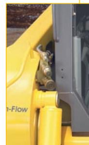
Il cofano motore è munito di molle assistite da cilindri a gas per facilitarne l'apertura. Fianchetti motore asportabili garantiscono un facile accesso ai punti di manutenzione.
