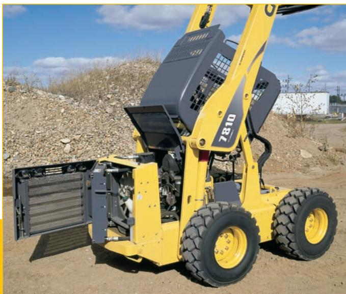
Un nuovo sportello posteriore, un coperchio motore e portello per l'impianto di raffreddamento forniscono un accesso rapido e completo al vano motore.
